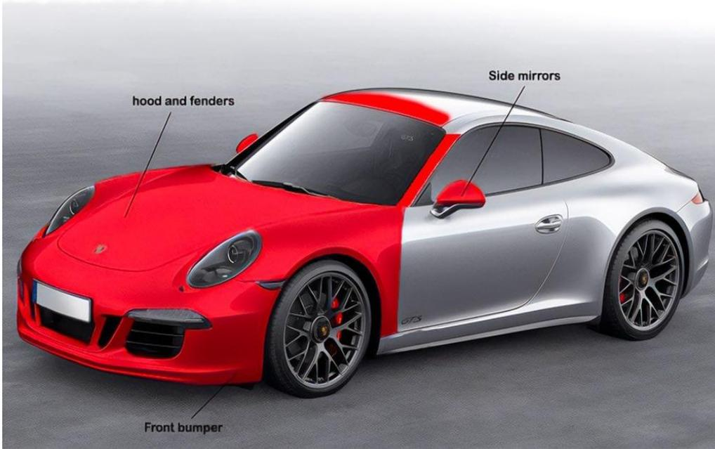
→ Aplicación de Paint Protection Film  **cubriendo parachoques, aletas, capot, faros y espejos retrovisores**
